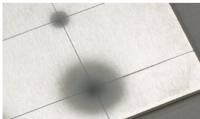
Arenado preciso y económico. Arriba: foco de chorreado Renfert. Abajo: foco de chorreado de un competidor
