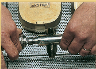
Sistema rápido de desmontaje y montaje del árbol de aspersión.
