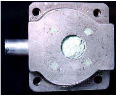
18. Abrir la mufla, sacando los 4 tornillos y golpeando con un martillo la parte superior, como muestra la figura 13.
